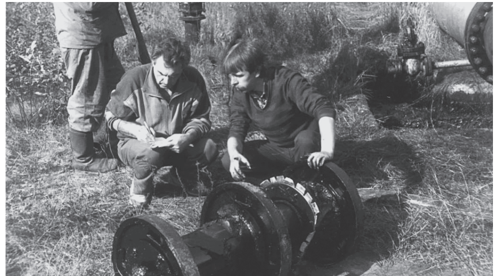
● В. Кондратьев и Е. Миронов осматривают прибор скребок-калибр Фото из архива АО «Транснефть - Диаскан»
